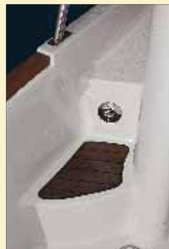
En bañera y al inicio del pasillo lateral contamos con un peldaño que eleva la cubierta a un nivel superior. Está forrado en teca, garantizando una superficie antideslizante.
