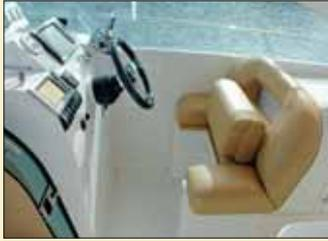
En el asiento del piloto contaremos con el rulo delantero abatible para una conducción de pie.
